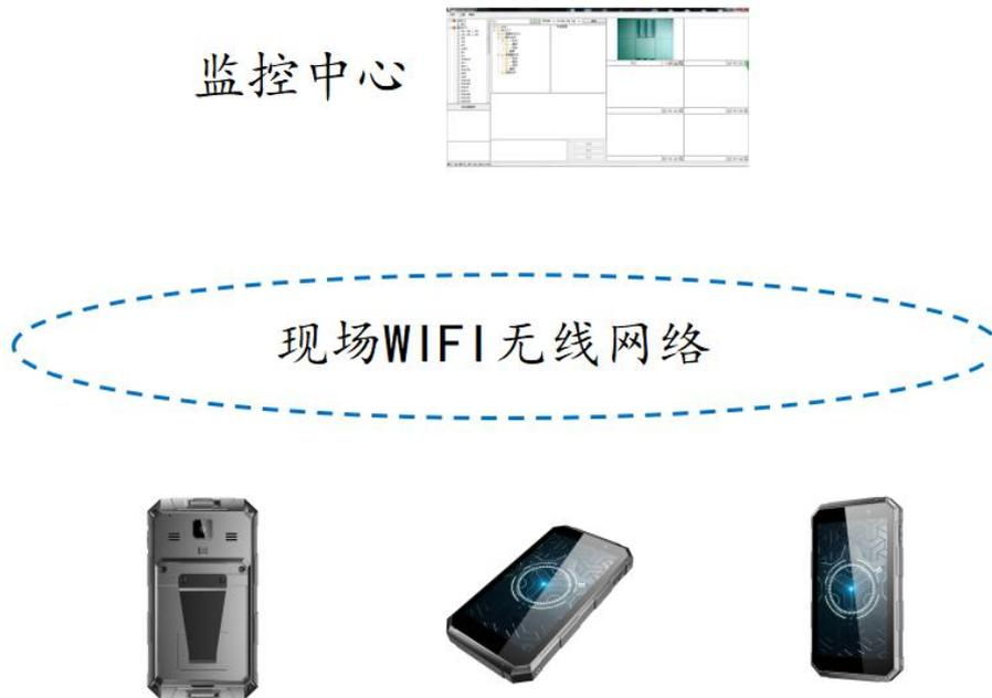
如上图所示，服务器和现场管控软件架设于监控中心，VOIP 手持对讲机由运维人员随身携带使用，现场 WIFI 无线网络由无线 AC 和无线 AP 组网而成，整个系统可以实现运维人员之间音视频对讲、和中心以及所有固定电话之间打电话，和 110、119、公网座机和手机之间打电话、将现场发现的问题拍照、拍视频上传到中心、中心定位运维人员的位置、中心查看运维人员巡逻的轨迹等功能，是运维人员工作的利器。
